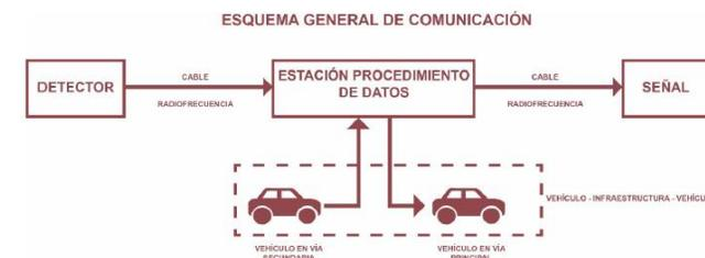
Tecnología de intercambio de información: advierte de la **proximidad de vehículos en una intersección de acceso a una convencional por una vía de un solo carril**, mediante detectores de presencia en el asfalto.
